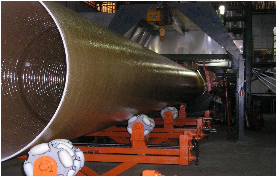
O processo hoop-chop de laminação contínua faz tubos de qualquer comprimento. Cortesia NOV/Polyplaster
