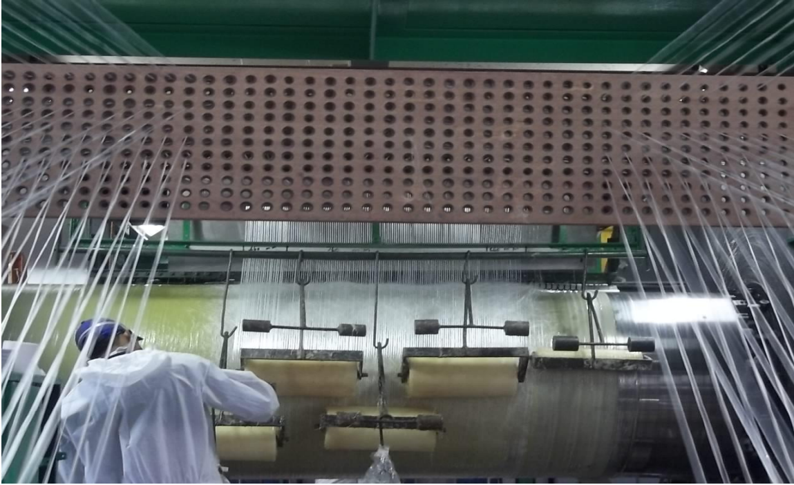
Processo hoop-chop de laminação contínua. As fibras UD são enroladas secas. A resina e as fibras picadas caem por gravidade na geratriz superior do mandril. Esse processo aplica também núcleos de areia para fazer tubos enterrados. Cortesia NOV/Polyplaster
