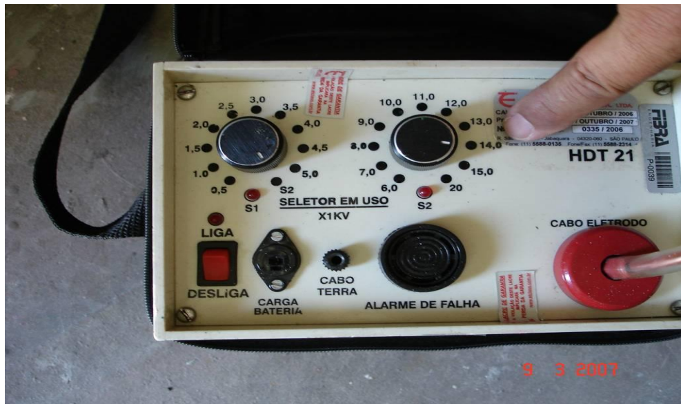
Aparelho Holiday Detector regulado para tensão de saída de 14 KV
