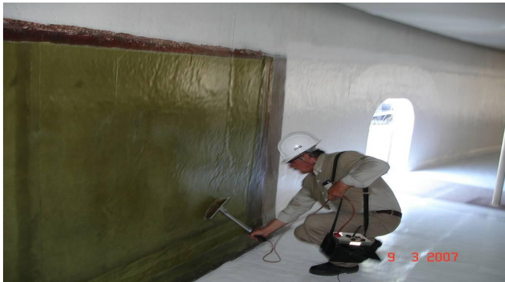
O teste de fásca é feito passando a escova energizada sobre a superfície do revestimento.
