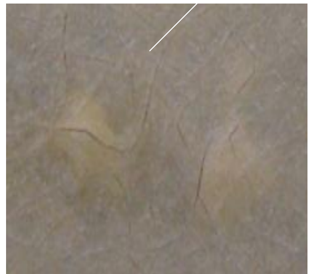
Figura 4 Mostra a vista interna da placa retirada do costado. O laminado de cor amarela na esquerda é a barreira de corrosão. O laminado estrutural tem cor escura. Como esperado, a alta absorção de formol pela resina causa bolhas osmóticas e trinca o liner. As bolhas podem ser vistas na foto da esquerda. As trincas são vistas na foto da direita. A barreira de corrosão delaminou do laminado estrutural.
