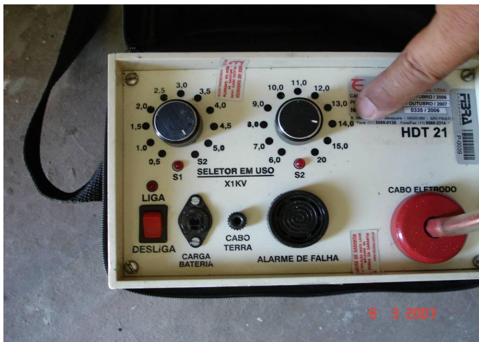
Aparelho Holiday Detector regulado para tensão de saída de 14 KV
