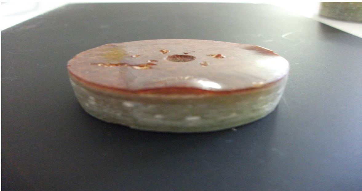
Corte transversal de bolha osmótica seca, mostrando que a resina sofre deformação plástica sob o liner e não retoma a geometria original depois que a água evapora.
