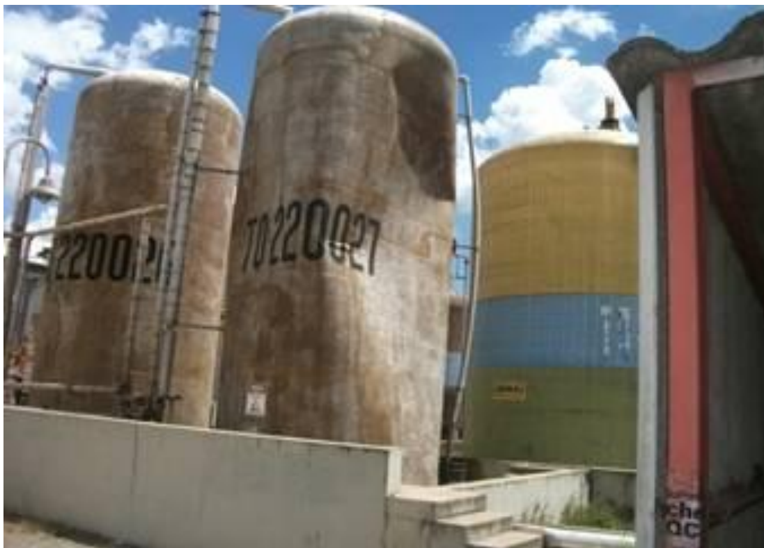
Figura 1 Mostra o tanque de formol, colapsado por vácuo.
