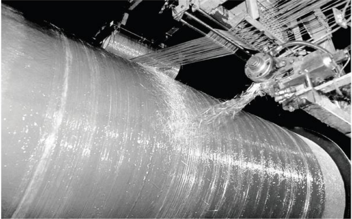
O processo hoop-chop aplica fibras UD secas, sem resina, na direção circunferencial. Esta foto mostra as fibras picadas e a resina sendo aplicadas com pistola. Este processo é muito usado para fazer tanques, dutos e tubos de grandes diâmetros.
