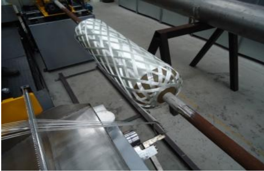
O enrolamento helicoidal pode fazer vasos de pressão sem emendas entre o cilindro e as calotas. Foto cortesia IBCom.
