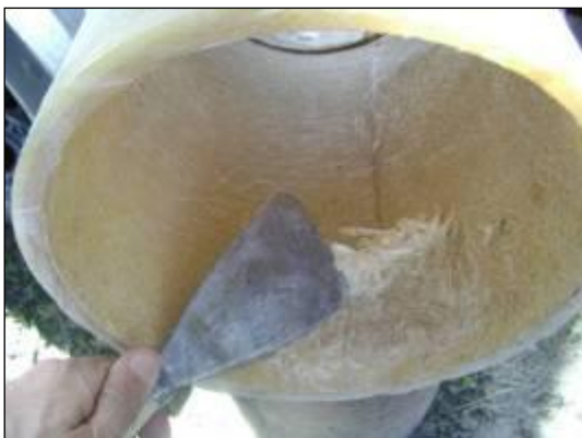
Fotos que mostram a penetração do ambiente agressivo na barreira de corrosão de tubos. A foto na direita mostra barreira totalmente penetrada. Fotos cedidas pela Cenibra.
