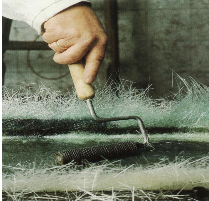
Figura 3 Laminação com pistola. A roletagem do laminado é feita antes da resina gelear.
